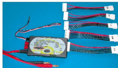
Der neue Intelli-Balancer unterstützt den Spannungsausgleich von bis zu sechs Zellen. Über das Interfacekabel (links oben) kommuniziert er mit dem X-Peak-220-Lader. Es lassen sich auch zwei von den Equalizern kaskadieren (Master-Slave-Betrieb)
