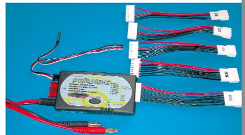
Der neue Intelli-Balancer unterstützt den Spannungsausgleich von bis zu sechs Zellen. Über das Interfacekabel (links oben) kommuniziert er mit dem X-Peak-220-Lader. Es lassen sich auch zwei von den Equalizern kaskadieren (Master-Slave-Betrieb)
